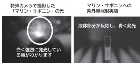
図-4 マリン・サポニンへの紫外線照射実験
